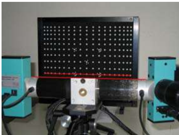
Рис.8. Выравнивание системы относительно калибровочной платы по горизонтали
