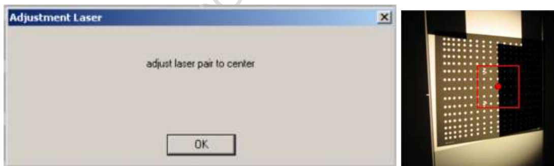
Рис.19 Фокусировка лазеров в центре калибровочной платы
