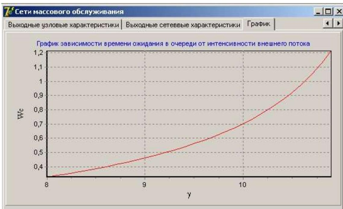
Рисунок 3.5 - График зависимости среднего времени ожидания заявки в сети от интенсивности внешнего потока
