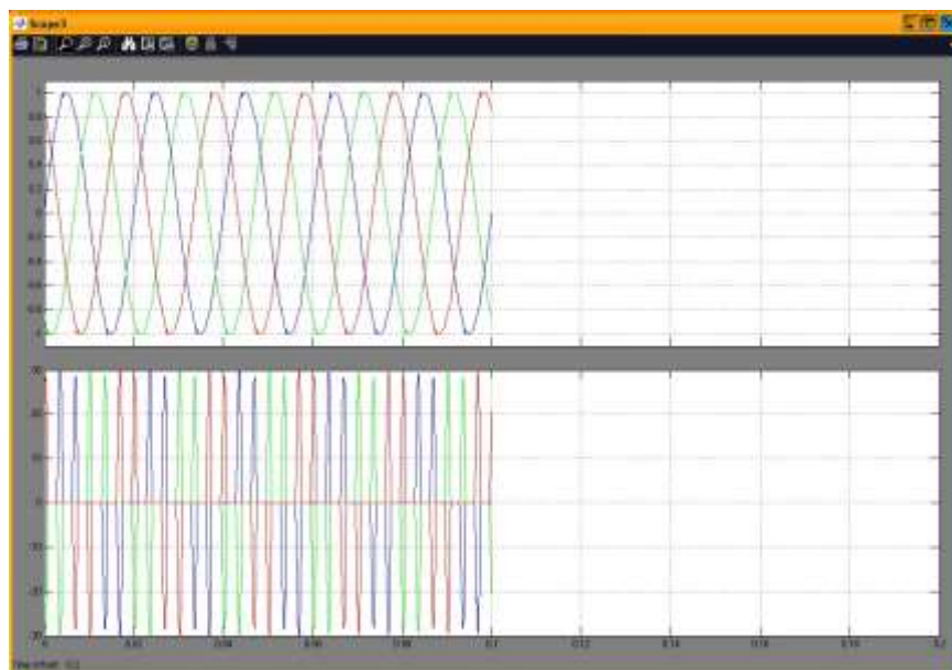
Рис. 8.10. Входные напряжения и тока преобразователя частоты
