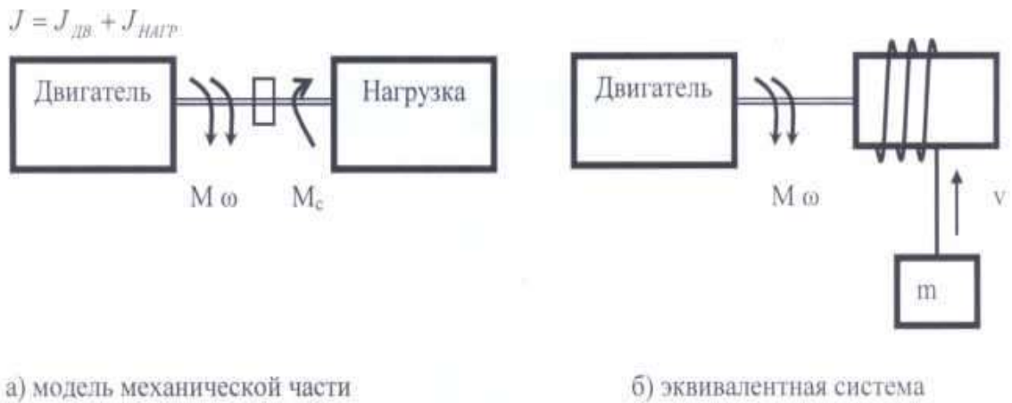
Рис. 4.3. Механическая система безредукторного лифтового привода
