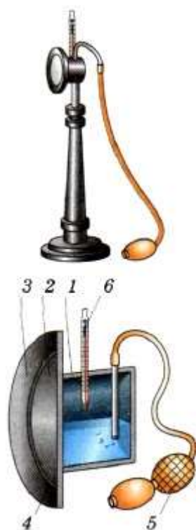
Рис. 23. Внешний вид и устройство конденсационного гигрометра
