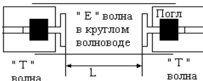
изменять затухание  $A_{дБ} \sim L$ . Используя точный микрометр можно с высокой точностью устанавливать требуемое значение (до 0.001 дБ).
