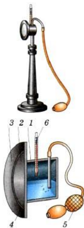
Рис. 23. Внешний вид и устройство конденсационного гигрометра
