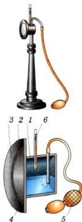
Рис. 23. Внешний вид и устройство конденсационного гигрометра
