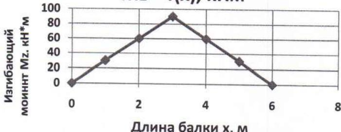
На левой половине пролета поперечная сила не зависит от x: Q = const. Это видно на рисунке. При  $L/2 \leq x \leq L$  слева от сечения на расстоянии x от левого конца находятся уже две силы Ra и P. В этом случае  $Q = \sum \text{слева} Y_i = Ra - P = -30 \text{ кН}$ . Поперечная сила также не зависит от x и постоянна на правой половине пролета. На эпюре Q в середине балки виден скачок на величину силы P = 60 кН.
