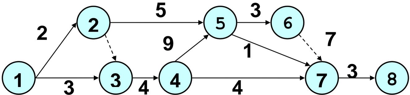
Рассчитать сетевой график аналитическим и табличным методом. Определить критический путь и резервы.
