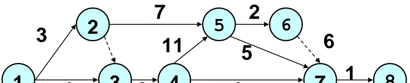
Рассчитать сетевой график секторным методом. Определить критический путь и резервы.
