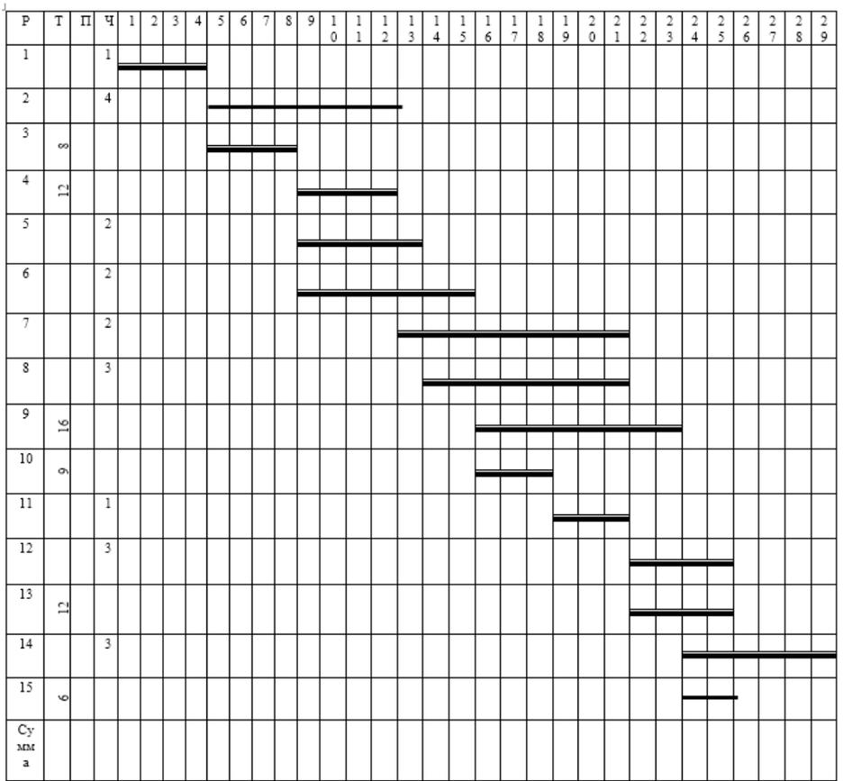
Задача 2: По линейному календарному графику построить график движения трудовых ресурсов. Рассчитать коэффициенты. Заполнить пробелы в таблице. На основании графика Ганта построить сетевой график.
