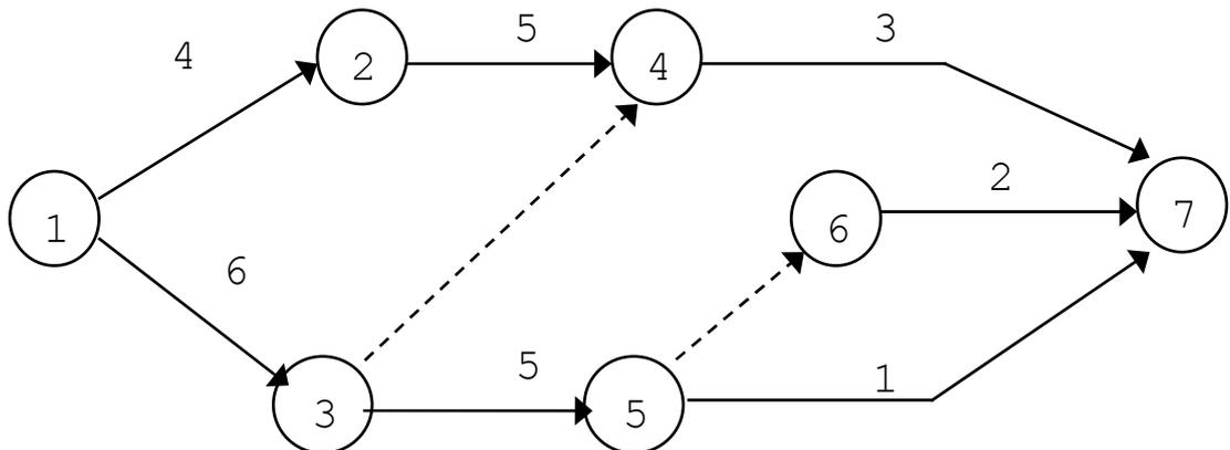
Рассчитать сетевой график секторным и дробным методом. Определить критический путь и резервы.
