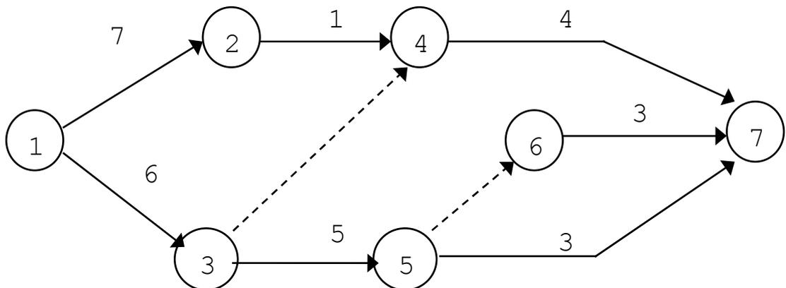
Рассчитать сетевой график секторным и табличным методом. Определить критический путь и резервы.
