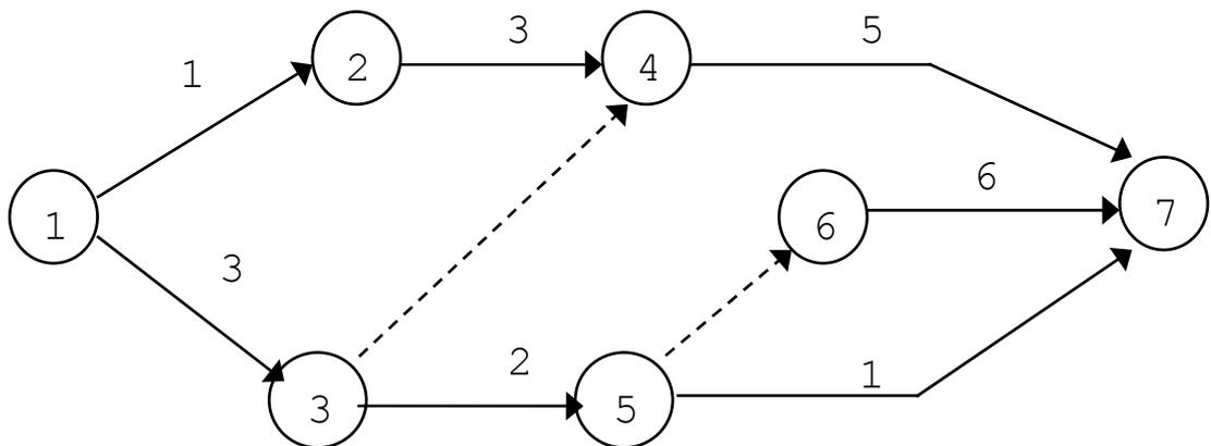
Рассчитать сетевой график аналитическим и дробным методом. Определить критический путь и резервы.
