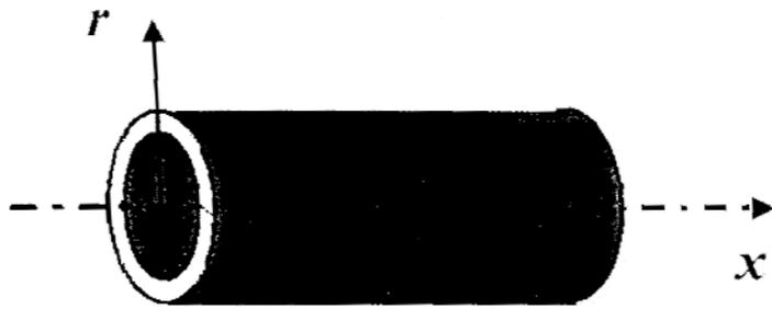
материалов. Обычно электроды в виде тонких слоев металла наносятся на внешнюю и внутреннюю поверхности трубы, а торцы трубки остаются непокрытыми. Под действием разности потенциалов между внутренним и
