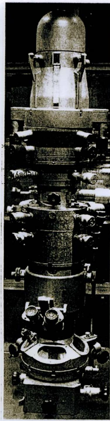
Рис.2.8. Электронный микроскоп
