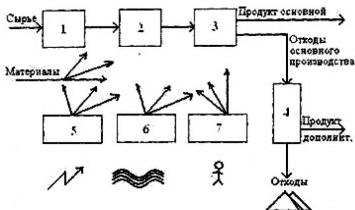
а) выделение продукта; б) санитарная очистка и утилизация отходов; в) подготовка сырья; г) водоподготовка; д) химическая переработка сырья; е) энергетическая система; ж) система управления.
