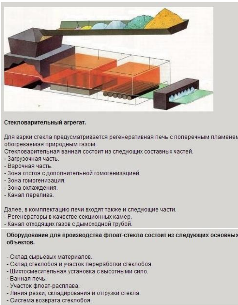
Рис. 34. Технологическая цепочка для получения стекла флоат-способом
