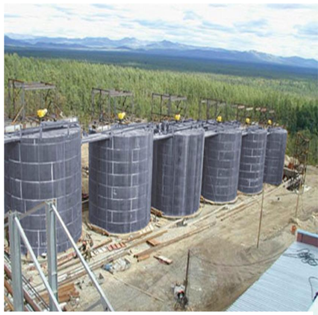
Рис. 12. Общий вид каскада реакторов (V-1000 куб.м) на месторождении Хаканджа. [www.Zielenski.narod.ru]
