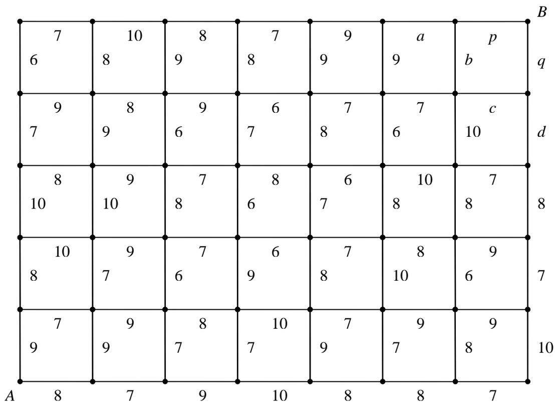
Требуется методом динамического программирования построить между пунктами *A* и *B*, имеющий минимальную суммарную стоимость строительства.
