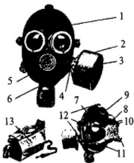
Рис. 4.5. Противогаз ГП-7: 1 – лицевая часть; 2 – фильтрующе-поглощающая коробка; 3 – трикотажный чехол; 4 – узел клапана вдоха; 5 – переговорное устройство (мембрана); 6 – узел клапанов выдоха; 7 – обтюратор; 8 – наголовник (затылочная пластина); 9 – лобная лямка; 10 – височная лямка; 11 – щёчные лямки; 12 – пряжки; 13 – сумка
