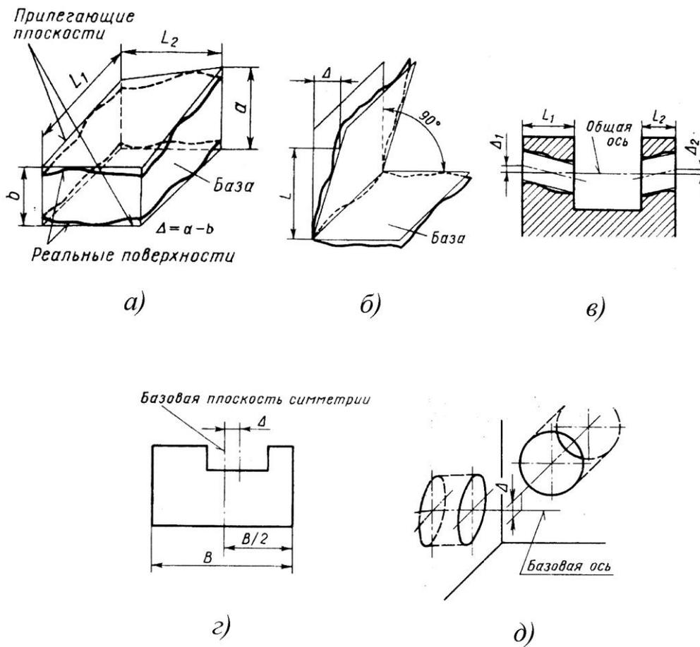
Рисунок 29. Схемы отклонений расположения поверхностей:
