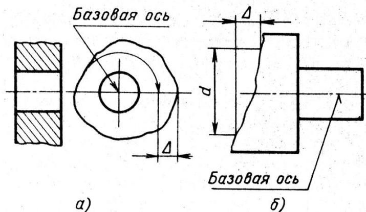
Рисунок 30. Схемы суммарных отклонений формы и расположения поверхностей:
