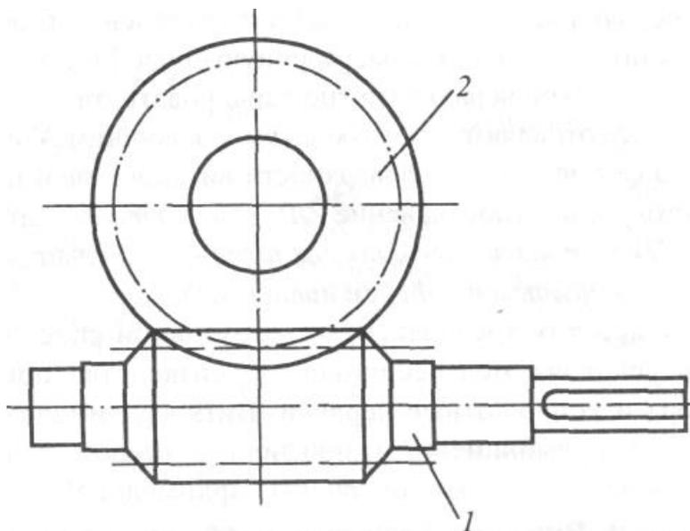
Рис. 2. Схема червячного зацепления
