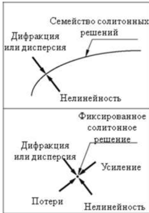
Рис. 1.2. Качественное различие между солитонными решениями в гамильтоновых и диссипативных системах
