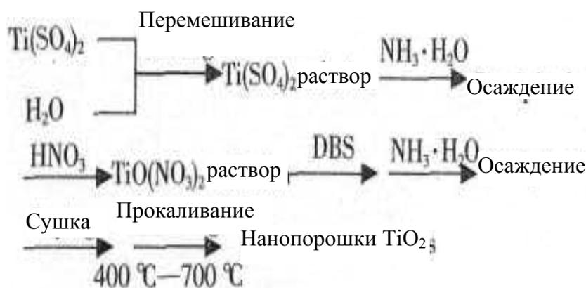
Рис. 97. Схема получения nano- $TiO_2$  (DBS-додецилсульфоната бензола)
