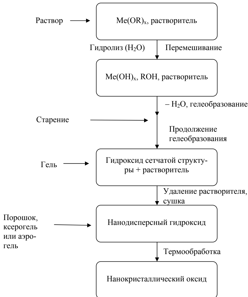
Рис. 3.1. Схема получения порошков оксидов металла золь-гель способом
