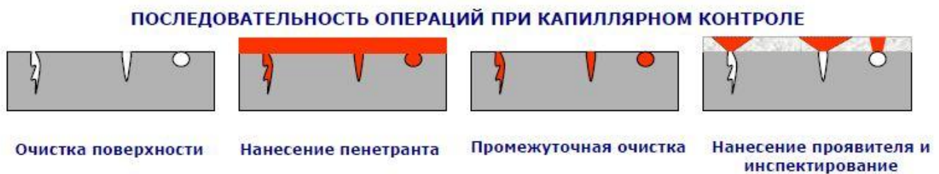
Рис.2.2. Последовательность операций при капиллярной методе
