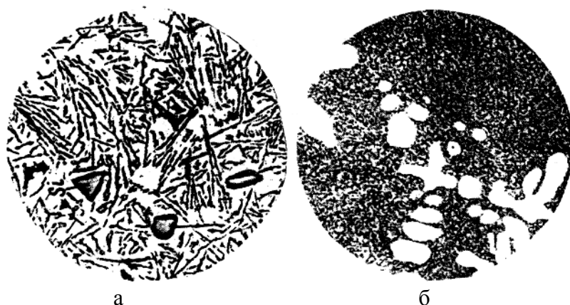
Рис.12.2. Микроструктура алюминиевого сплава АЛ2, х 250: а - литой немодифицированный: \alpha -твердый раствор и \beta -кремнистая фаза игольчатой формы; б - модифицированный: \alpha -твердый раствор и эвтектика тонкого строения
