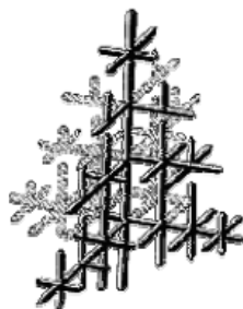
Рис.12. Схема древовидного кристалла (Д.К. Чернов)
