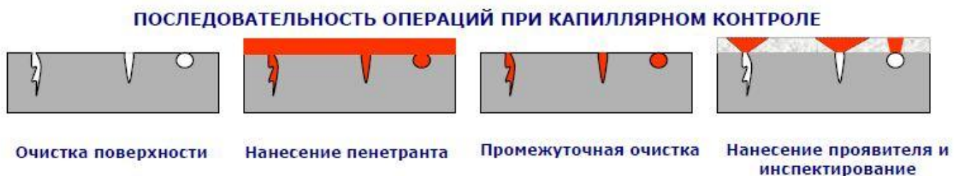
Рис.2.2. Последовательность операций при капиллярной методе
