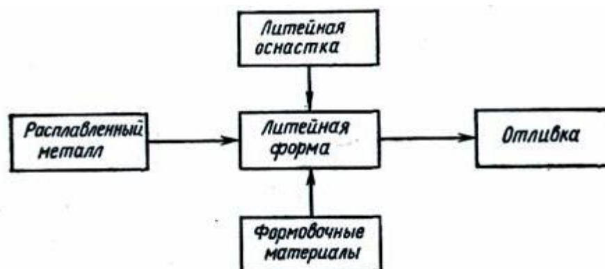
Рис. 34. Схема технологического процесса получения отливок в песчаных формах
