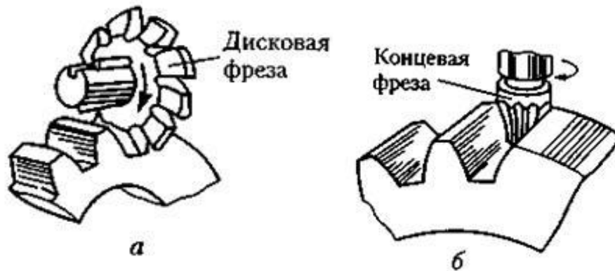
Рис. 38. Фрезерование зубьев цилиндрического колеса
