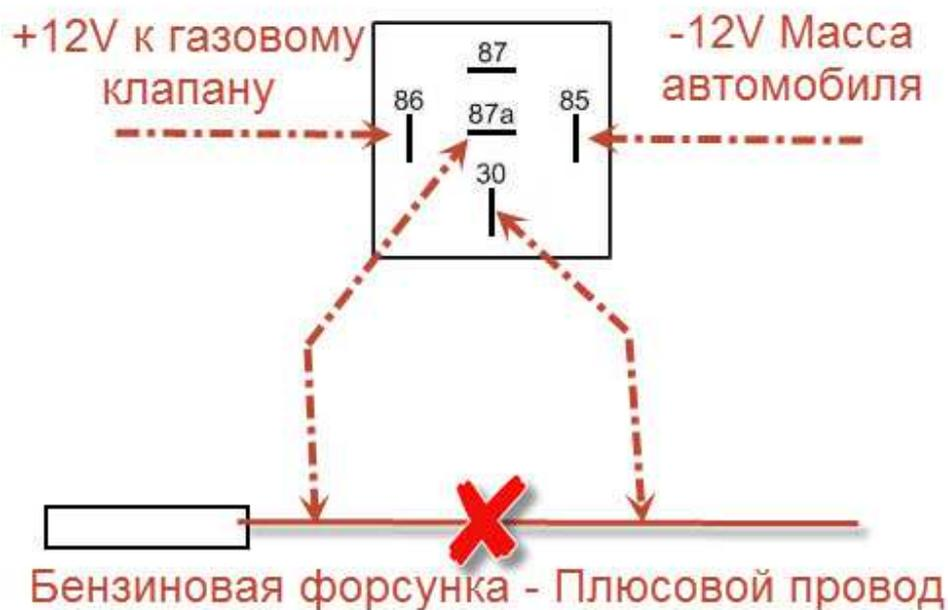
Реле используется пяти-контактное. Контакты 87а и 30 нормально замкнуты, при подачи питания на 86 контакт они размыкаются и питание на форсунки не идет. Как правило, бензиновые форсунки управляются минусом, поэтому сколько бы ни было форсунок установлено на двигателе, провод питания на них идет один, а потом расходится на все форсунки. Нужно только найти где он расходится и разорвать общий, либо разорвать все плюсовые провода и подключить их по данной схеме параллельно.
