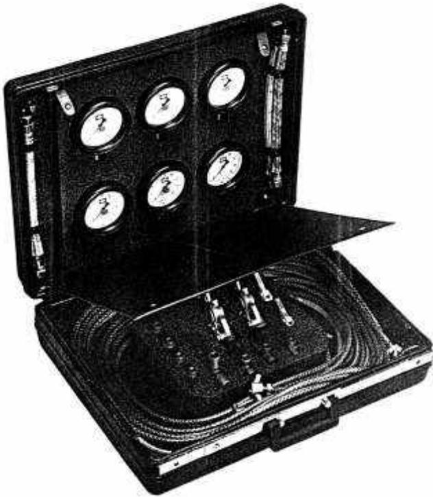
Рис. 15. Диагностический комплект для проверки пневмопривода
