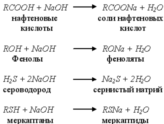
Рисунок 1.4 – Химические реакции при щелочной очистке нефтяных дистиллятов
