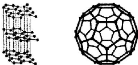
Рис. 18. Кристаллические решетки аллотропных модификаций углерода: a – графита; b – фуллерена
