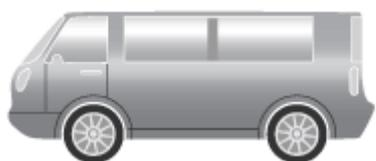
Однообъемный пассажирский кузов, центр рулевого колеса которого находится перед передней осью автомобиля.
