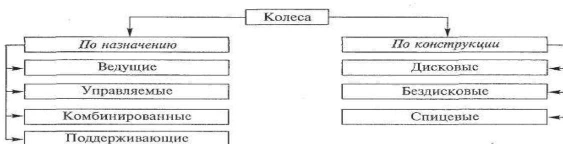
Рис. Типы колес, классифицированные по различным признакам
