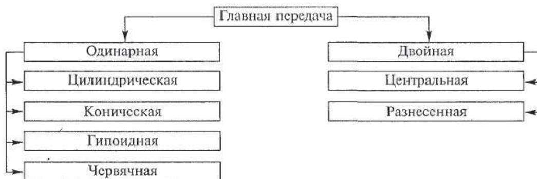
Рис. Типы главных передач
