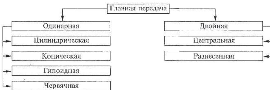
Рис. Типы главных передач
