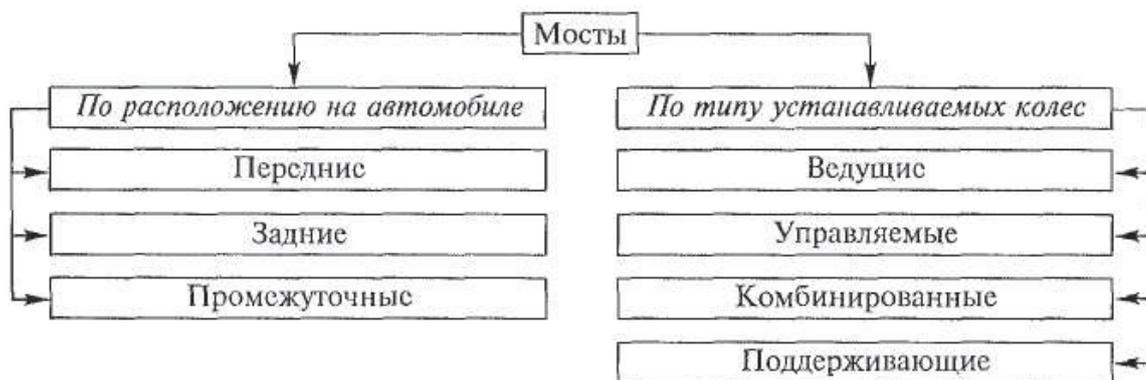
Рис. Типы мостов автомобилей, классифицированные по различным признакам
