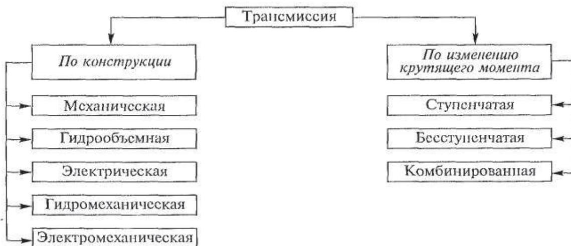
Рис. Типы трансмиссий автомобилей, классифицированные по различным признакам
