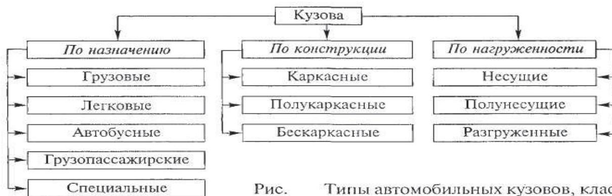
Рис. Типы автомобильных кузовов, классифицированные по различным признакам
