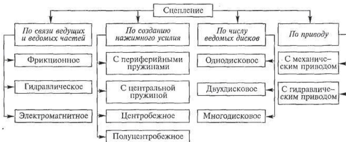
Рис. Типы сцеплений, классифицированные по различным признакам
