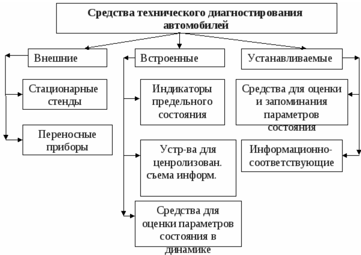
Рис.2. Классификация средств технического диагностирования автомобиля
