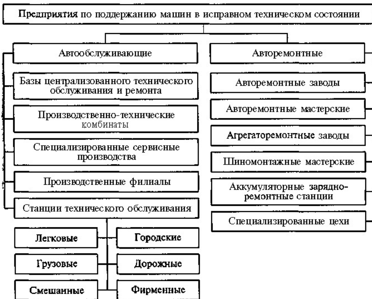
Рисунок 1 - Классификация предприятий по поддержанию машин в исправном техническом состоянии
