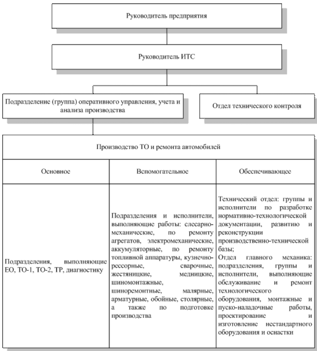
Рисунок 1 - Обобщенная схема организационно-производственной структуры ИТС АТП
