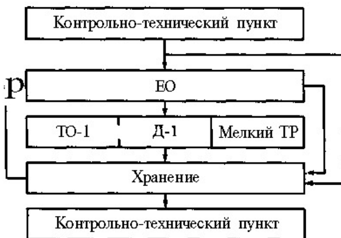
Рисунок 6 - Функциональная схема эксплуатационного предприятия (филиала)
