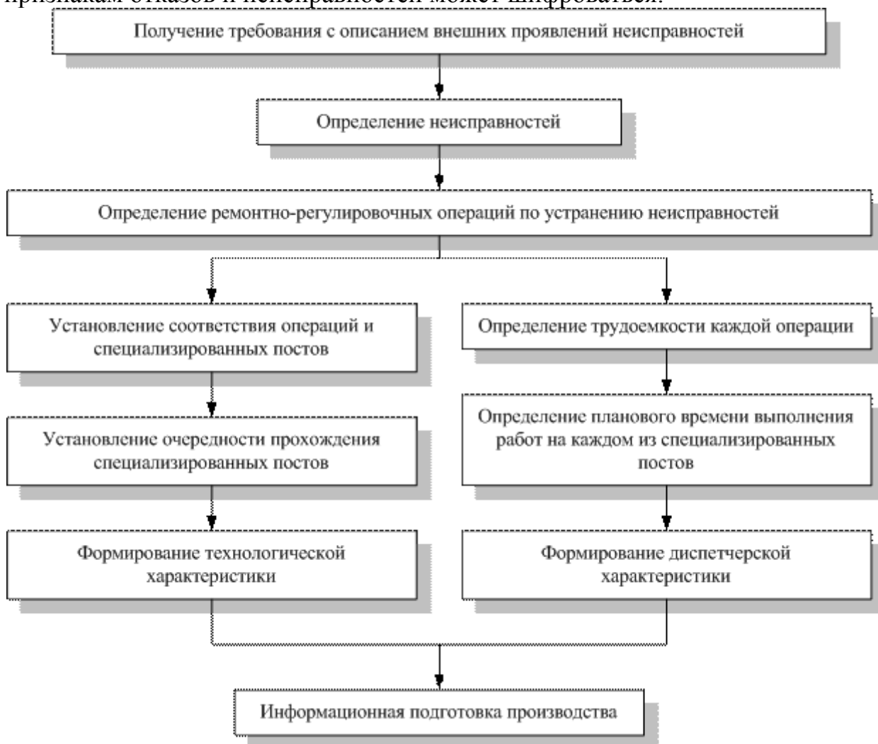
Рисунок 6 - Структурная схема алгоритма формирования диспетчерской и технологической характеристик требования (автомобиля)
