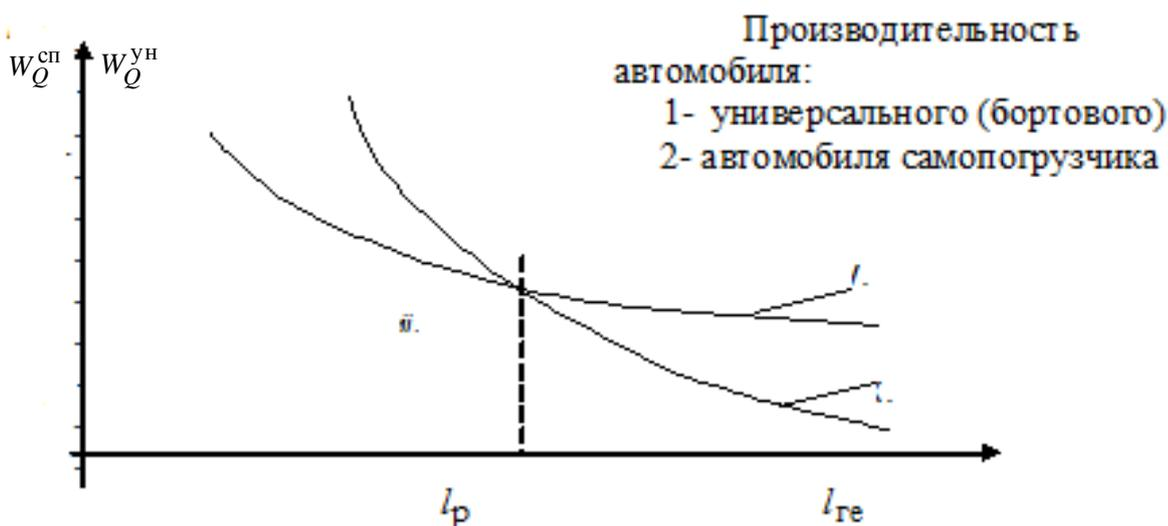
**Рис.13. График изменения производительности универсального и специализированного автомобиля**
