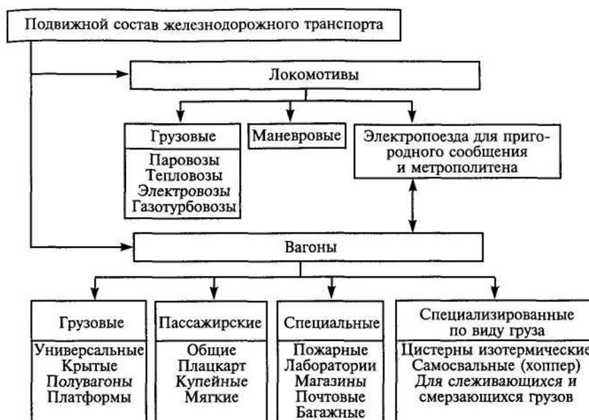
Рис. 4.3. Классификация подвижного состава железнодорожного транспорта
