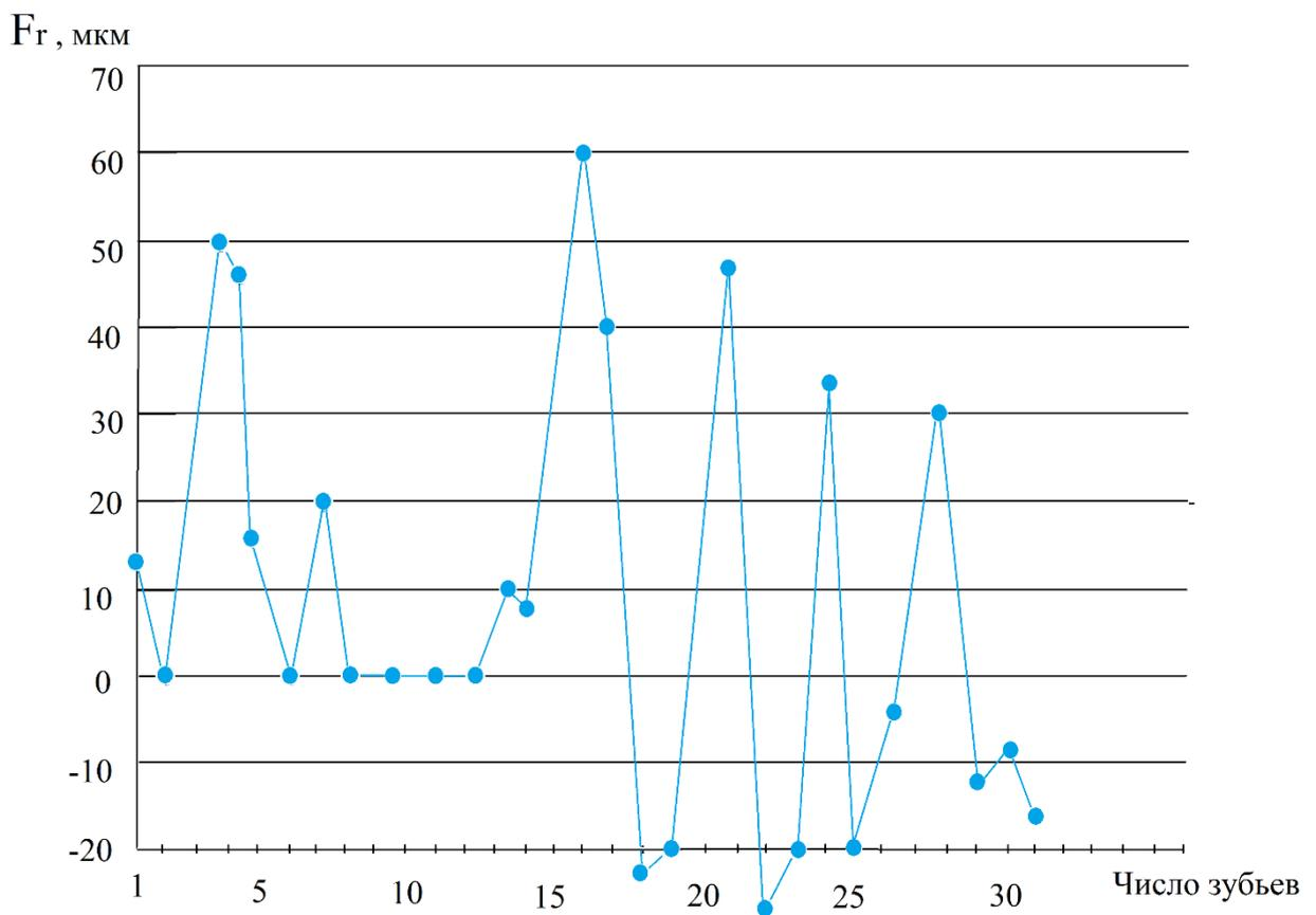
Рис. 3. График зависимости радиального биения от числа зубьев
