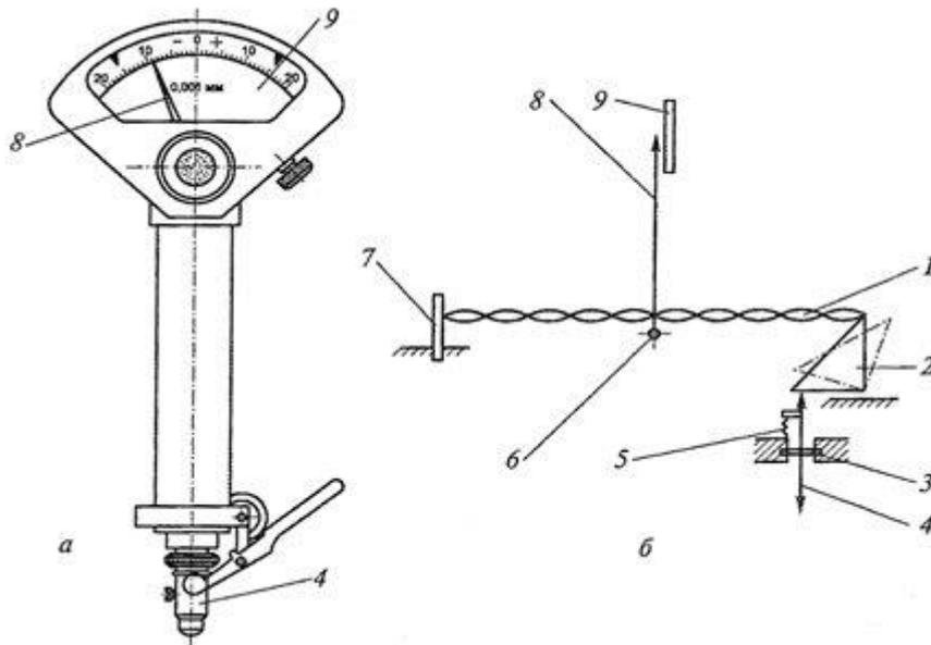
Рис. 6. Измерительная пружинная головка и ее схема (б):
