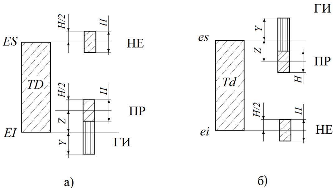
Рис. 2. Схема расположения полей допусков для размеров до 180 мм:
