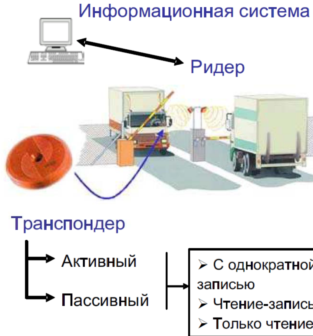
Рисунок 3. Считывание данных с радиочастотных меток
