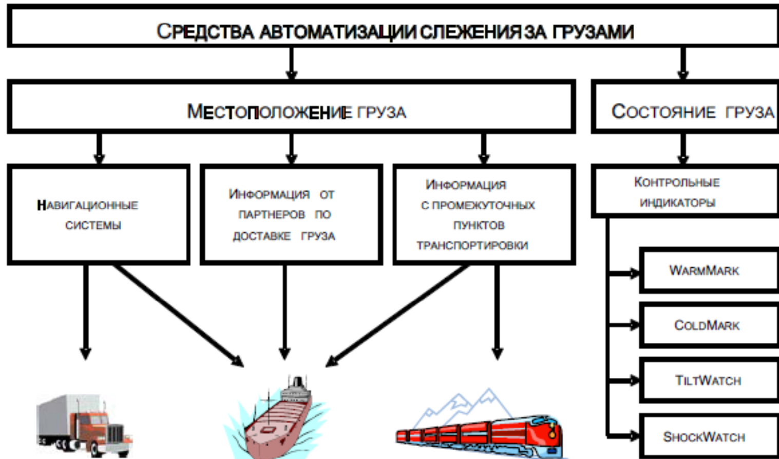
Рис. 7. Схема использования средств автоматизации слежения за грузами на транспорте
