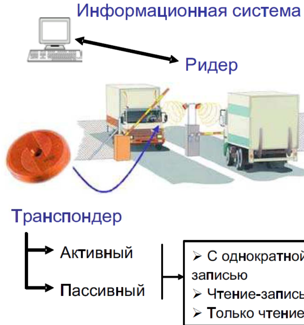
Рисунок 3. Считывание данных с радиочастотных меток
