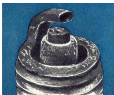
г - замасленная свеча
