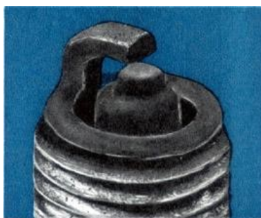
в - закопченная свеча
