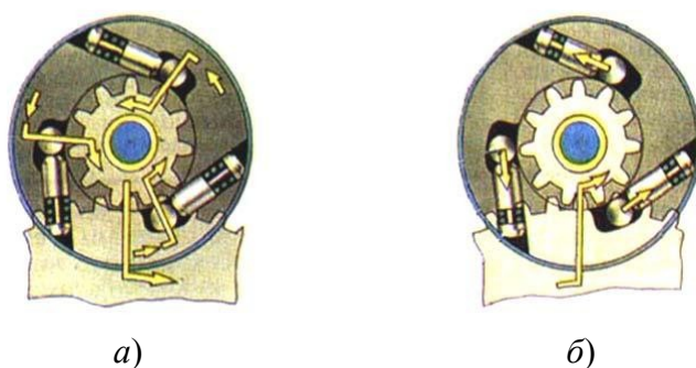
Рисунок 2.6 Схема работы роликовой муфты свободного хода при пуске (а) и после пуска (б) двигателя автомобиля
