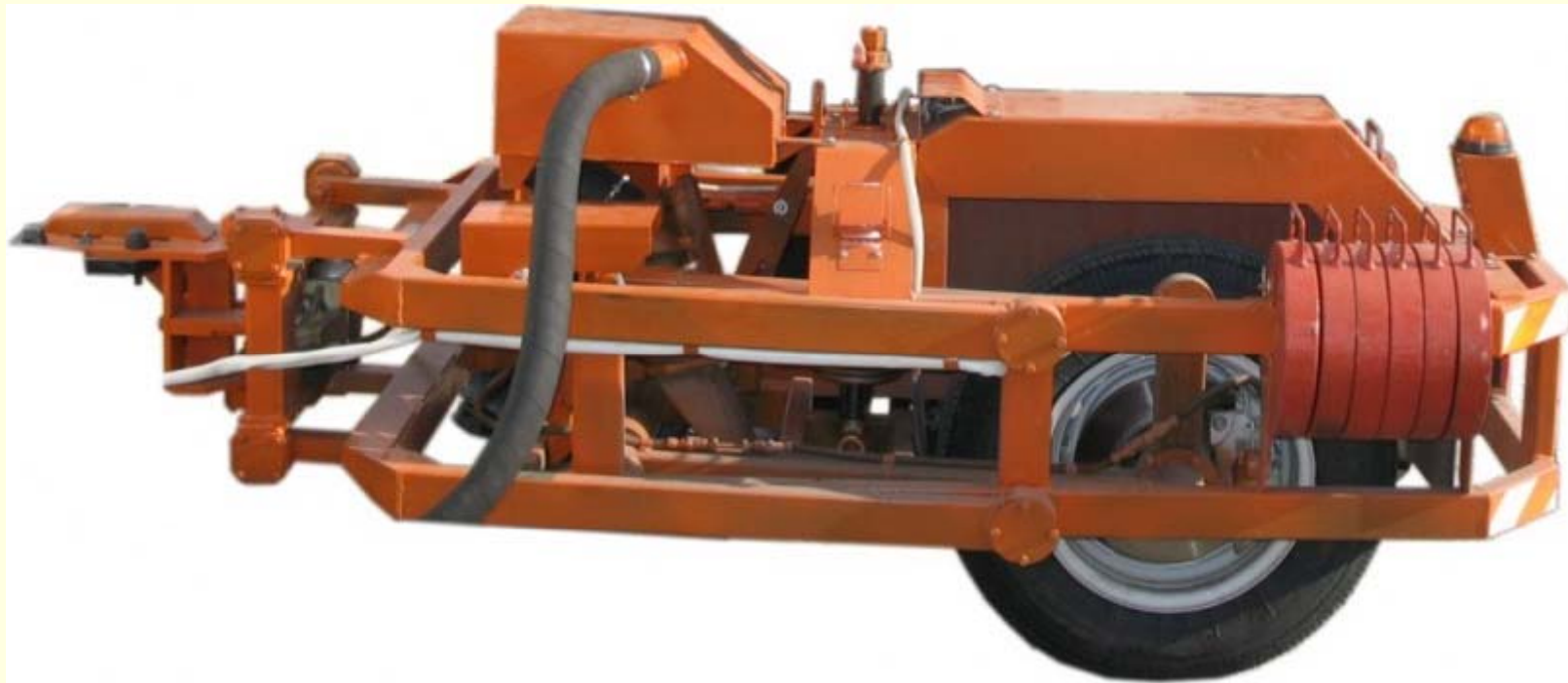
Рисунок 5. Динамометрический прицеп типа ПКРС-2У
