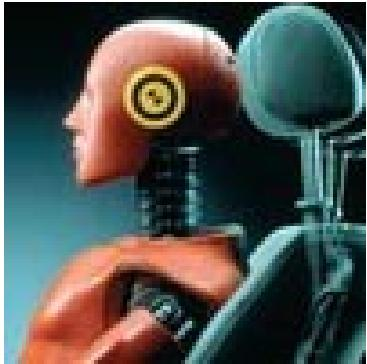
Роль подголовника – предотвратить резкое движение головы во время аварии. Поэтому следует отрегулировать высоту подголовника и его позицию в правильное положение. Современные подголовники имеют две степени регулировки, позволяющие предотвратить травмы шейных позвонков при движении «взахлест», столь характерных при наездах сзади.
