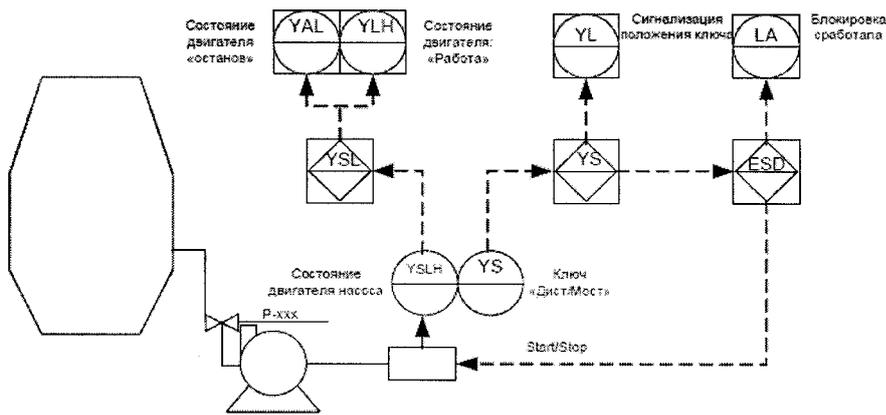
21. Какой стандарт использовался при построении данной функциональной схемы? Опишите данную схему
