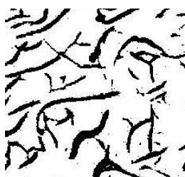
Серый чугун (металлическая основа и пластинчатый гра- фит)
