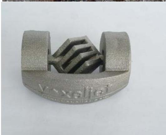
Рис. 4. Пример изготовления отливки из алюминиевого сплава литьем в песчаную форму, полученную при помощи 3D-печати [6]
