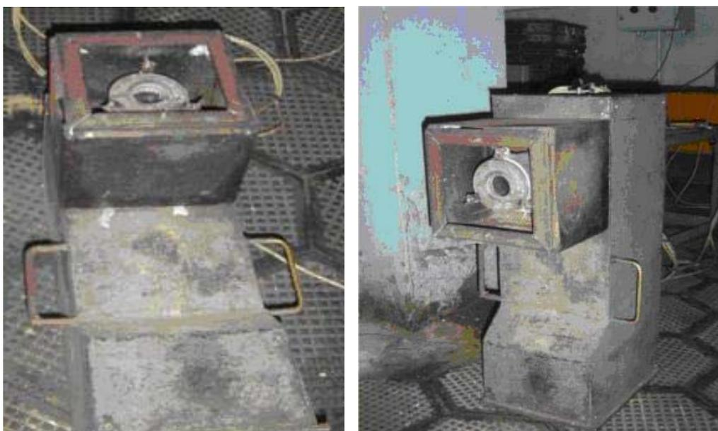
Рис. 15. Опытно-экспериментальная установка центробежного литья
