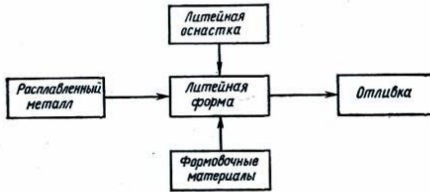
Рис. 2.1. Схема технологического процесса получения отливок в песчаных формах
