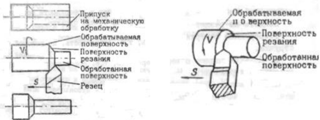
Рис. 8.2. Токарная обработка проходным резцом
