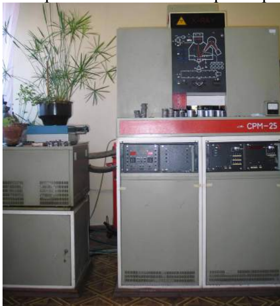
Рис. 14. Экспресс-анализатор химического состава сплавов СРМ-25.
