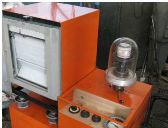
Рис. 20 - Аппарат газомер типа LGT
