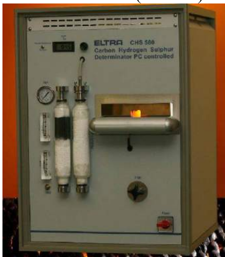
Рис. 17. Анализатор ELTRA CHS-580 (углерода, водорода и серы).
