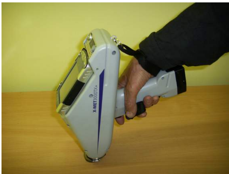
Рис. 13. Портативный рентгеновский спектрометр X-MET 300.
