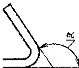
Рис.15. Схема измерения угла изгиба после снятия усилия
