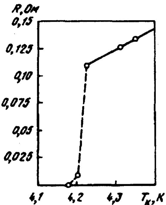
Рис.2. Эффект сверхпроводимости ртути в эксперименте
