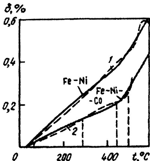
Рис.4. Температурные зависимости относительного изменения длины легко- (1) и тугоплавкого (2) стекла и соответствующих сплавов Fe—Ni и Fe—Ni—Co
