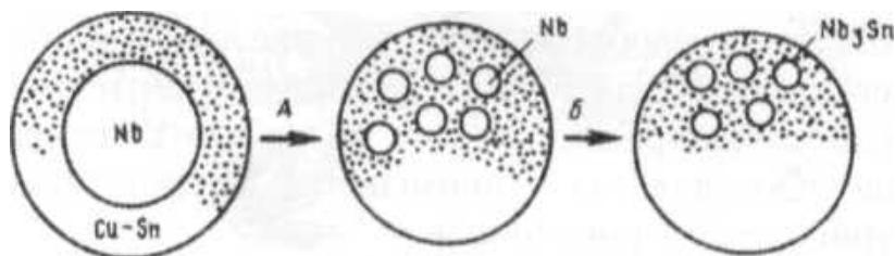
Рис. 4. Схема бронзовой технологии изготовления многожильных проводов на основе Nb<sub>3</sub>Sn:
