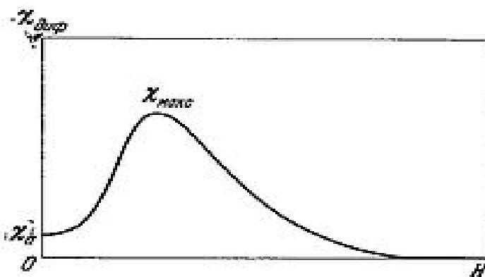
Рис.1. Кривая зависимости магнитной восприимчивости от напряжённости магнитного поля Столетова
