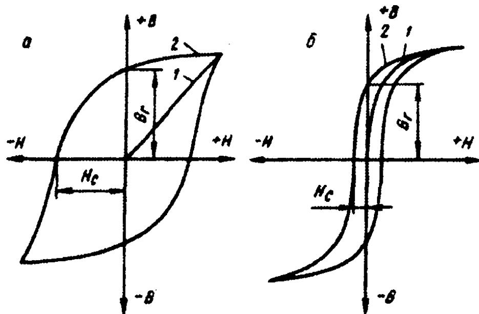
Рис.1. Зависимость магнитной индукции  $B$  от напряжённости магнитного поля  $H$ :
