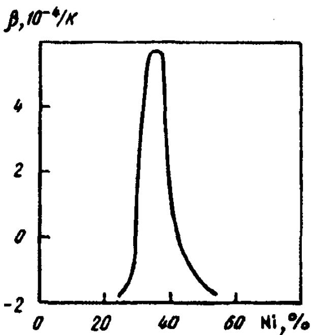
Рис. 3. Температурный коэффициент модуля упругости сплавов Fe—Ni
