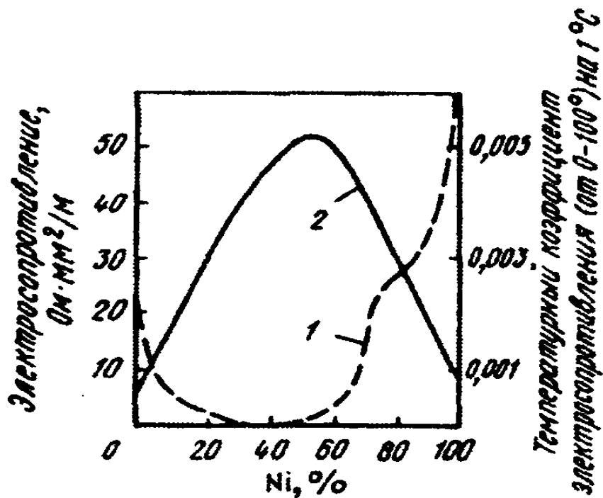
Рис. 2. Электрические свойства сплавов Cu—Ni:
