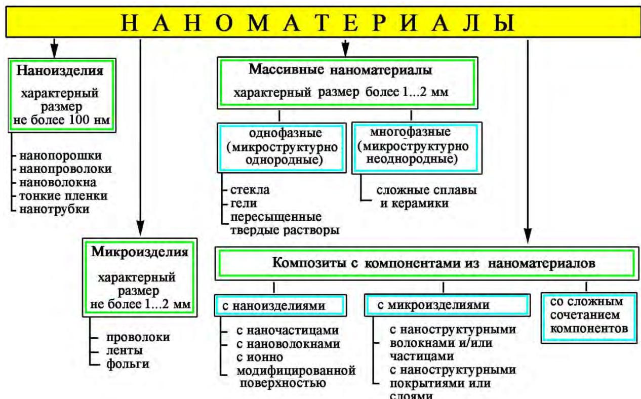
Рис. 2. Классификация наноматериалов
